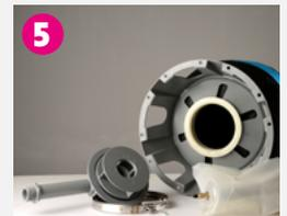
5 Nach Einsetzen die V-Bandklemme schließen
