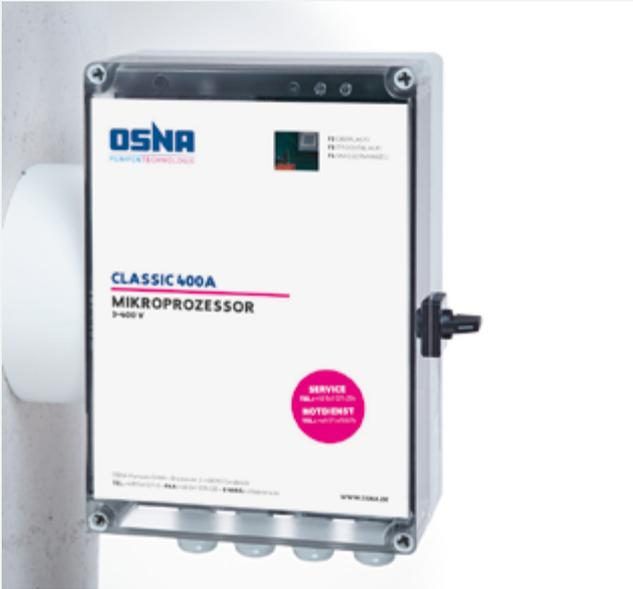
Elektronische Steuerung Typ Classic 400A zur Steuerung und zum Schutz von direkt anlaufenden Einzelpumpen bis max. 11 A mit digitaler Anzeige der Betriebszustände. Wahlweise für automatischen oder manuellen Betrieb mit Ansteuerung über Druckschalter.
